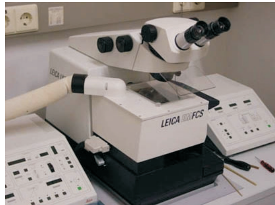
Mikrotom: ULTRACUT UCT (Leica) mit Kryokammer EM FCS (Leica)
