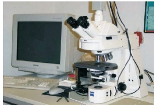
Lm: Axioplan 2 mit Digitalkamera und Heiztisch (Zeiss)
