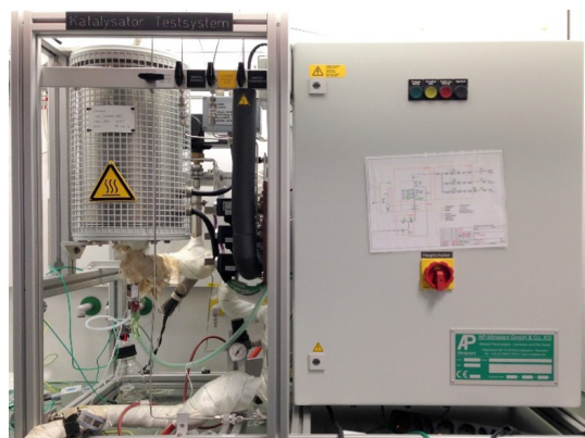
Abb. 2: Testreaktor zur Bestimmung der Reaktoraktivität. Test reactor for evaluation of the catalysts activity.
