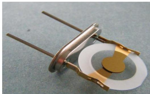
Abbildung 10: Bild des Quarzes
