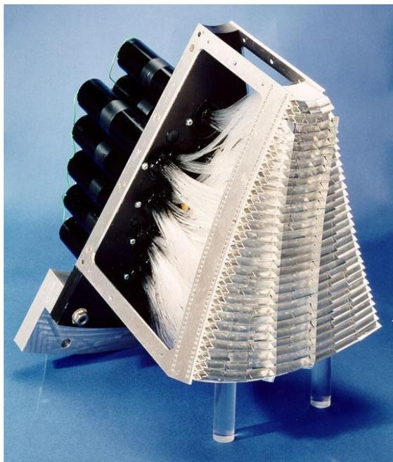
Abbildung 2.28: Diese Darstellung zeigt ein Detektormodul von einem GEM Detektor. Im Vordergrund sieht man den Szintillator, gekoppelt und Lichtleiter, die dann auf die hinten im Bild angeordneten Photomultiplier geführt werden.
