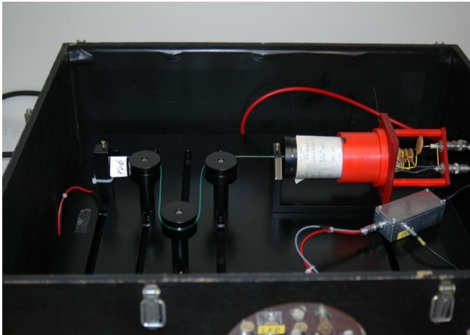
Abbildung 4.8: Auf der rechten Seite des Bildes sieht man den Photomultiplier mit seinem Dynodenspannungsteiler und den Vorverstärker in der silbernen Box. Links ist die LED fest in einem Aluminiumblock verklebt. Über die auswechselbaren Umlenkrollen wird dann zwischen LED und Photomultiplier die Fiber eingespannt.
