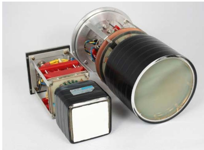
Abbildung 4.14: Bild von beiden ortsauflösenden Photomultipliern der Firma Hamamatsu. Links ist der R2487 und rechts die R3292 Röhre jeweils mit vier Vorverstärkern zur Auslese bestückt dargestellt. An der R2487 Röhre ist ein  ${}^6\text{Li}$ -Glas Szintillator mit weißer Reflektorfarbe gekoppelt.
