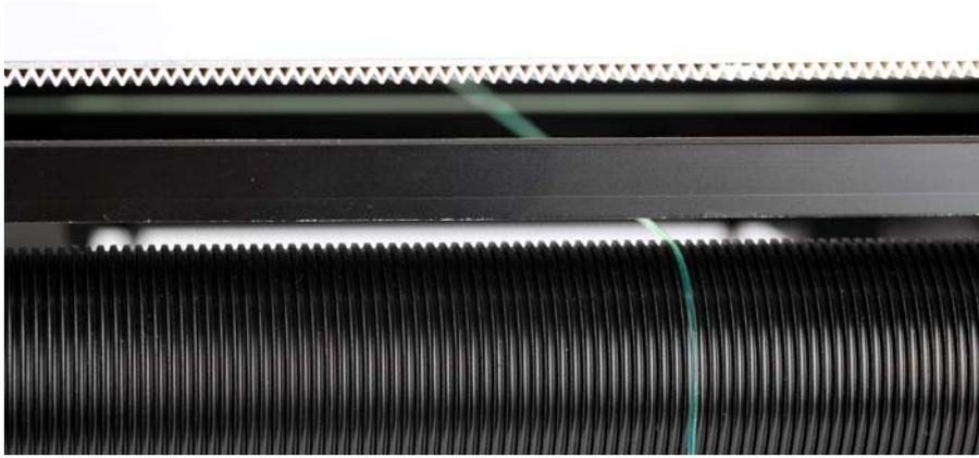
Abbildung 5.3: Im vorderen Teil sieht man eine Fiber die in der oberen Bildhälfte eine weitere Fiber aus der anderen Ebene kreuzt. Darüber angeordnet ist in weiß ein  ${}^6\text{LiF/Zns:Ag}$  Szintillator in V-Struktur dargestellt, welcher aber nicht in seiner endgültigen Position ist.
