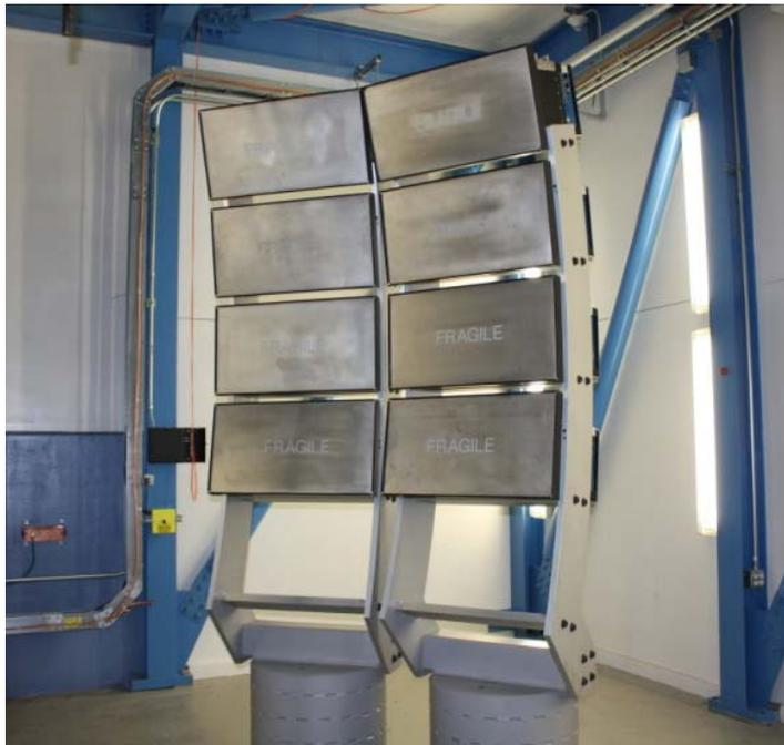
Abbildung 3.13 : Die einzelnen Detektormodule, hier 8, ermöglichen einen modularen und flexiblen Aufbau an POWGEN
