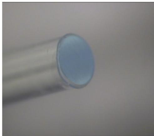
Abbildung 4.7: Polierte Faser. Es ist sehr gut sowohl der Kern der Faser als auch der Mantel (Cladding) um den Faserkern zu erkennen.
