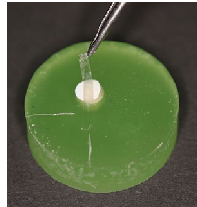
Abb. 6.1.9: Abkleben einer Probe mit Tesafilm
