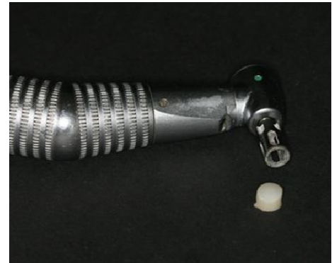
Abb. 6.1.3: Trepanbohrer mit Probe
