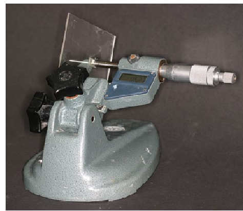
Abb.6.7.1.9: Dickenmessung der Probe
