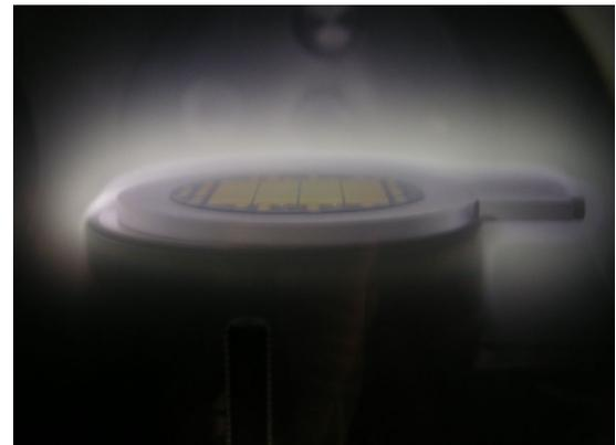
Abbildung 6.12: Mit Polymerpassivierung beschichteter Wafer im Rezipienten während des Descum-Prozesses mit einem  $\text{O}_2/\text{CF}_4$ -Plasma.
