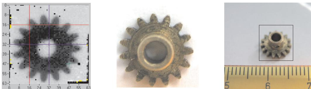
Abbildung 7.11: Korrigierte Röntgenaufnahme (links) eines Zahnrades (Mitte) mit etwa  $7$  mm Durchmesser (rechts). Aufnahmedaten:  $60$  kV Röhrenspg., Belichtung  $500$  ms, Detektorspg.  $400$  V. Die im Röntgenbild erkennbaren niedrigen Zählerstände entlang der Bildränder traten bereits im ANIN-Test des Auslesechips, d.h. ohne Röntgenstrahlung und Signalerzeugung durch den (Cd,Zn)Te-Halbleiter auf.
