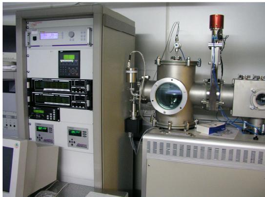
Abbildung 6.11: Plasma-Ionen-Ätzanlage (Fabrikat 4-TEC) für das Trockenätzen mit reaktiven Gasen. In dieser Anlage wurden alle Descum-Prozesse durchgeführt.
