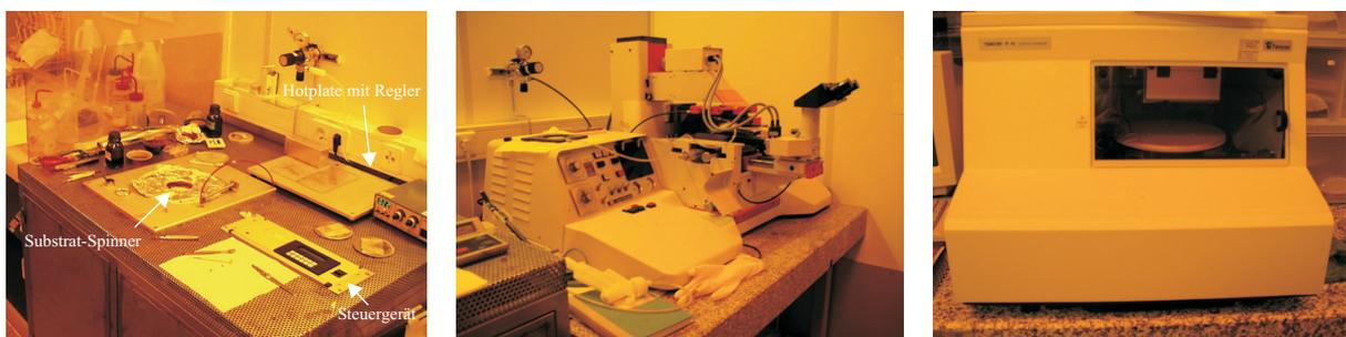
Abbildung 6.2: Im linken Bild sind der für die Schleuderbelackung benutzte Spinner sowie die Hotplates für die Ausbackschritte dargestellt. Das Bild in der Mitte zeigt den für die UV-Belichtungen verwendeten Karl Süss MJB 21-Mask-Aligner. Mit dem rechts dargestellten Profiler wurden die Schichtdicken und Strukturhöhen überprüft.
