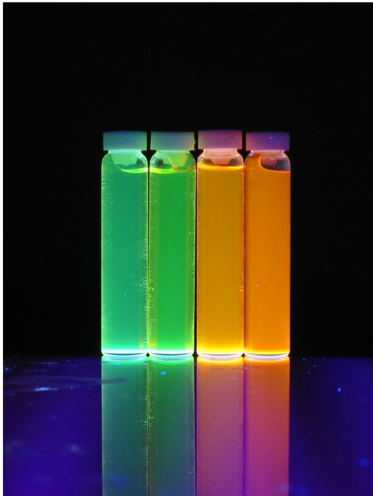
**Abbildung 6.9.:** *Bild von kolloidalen Lösungen von CdTe-Nanokristallen. Die Emissionswellenlänge nimmt mit zunehmender Rührzeit und Teilchengröße zu (Aufnahme: E. Kuçur).*
