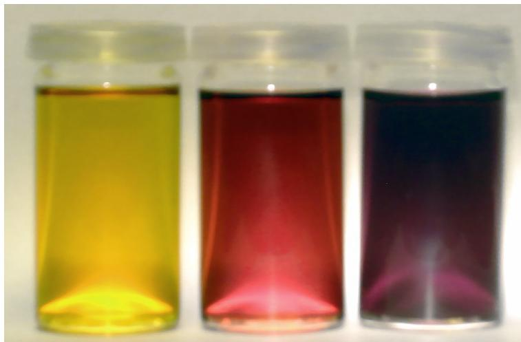
**Abbildung 6.8.:** Bild von kolloidalen Lösungen von Metall-Nanokristallen: links: Silber-Kolloid: gelb, Mitte: Gold-Kolloid: rot, rechts: koaguliertes Gold-Kolloid: blau (Aufnahme: E. Kuçur).
