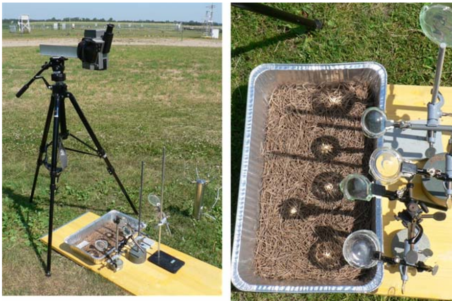
Abb. 1: Versuchsaufbau. Die Glasscherben wurden mithilfe von Stativen derart positioniert, dass sie das Sonnenlicht möglichst scharf auf eine Streuoberfläche konzentrierten; die Oberflächentemperatur der Streu wurde mit einer Thermografiekamera erfasst
