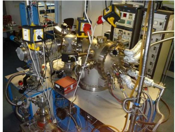
Abb. 6.1: Skizze der Kammeranordnung der Anlage, welche die drei Kammern und das Transfersystem abbildet (links, [128]) und Aufbau im Labor (rechts).
