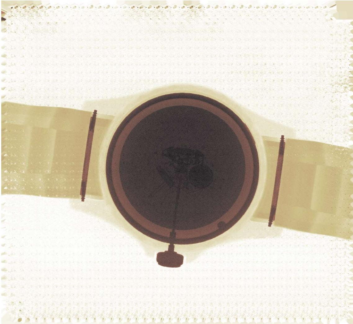
Abb. 8.23: gekachelte Röntgenaufnahme einer Uhr mit 38 x 35 Kacheln. Neben dem schwach absorbierenden Plastikgehäuse und -armband, sind auch die stark absorbierenden Metallfedern der Verschlüsse sowie das Uhrwerk mit Zeigern sichtbar. Vor allem in den Bereichen ohne Objekt und an den Rändern ist die Kachelung deutlich sichtbar.
