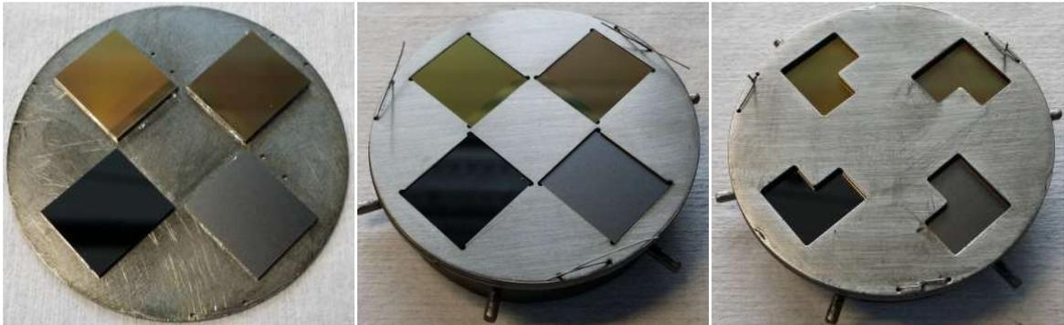
Abb. 6.9: Aufbringen von vier Substraten auf der Mo-Platte mit flüssigem Ga. Anschließendes Anbringen des Spacers und der Maske mit W-Drähten.
