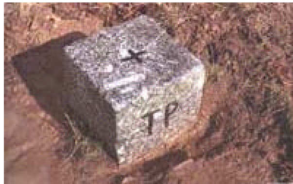
Abb. 10: TP in Form eines Pfeilers aus Granit (Quelle: LVA BW)
