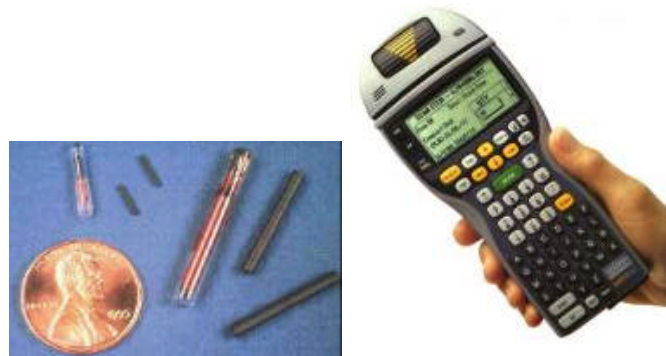
Abb. 2: Beispiel für RFID Transponder sowie Lese- und Schreibeinheit (Quelle: URL 7 und URL 8 )
