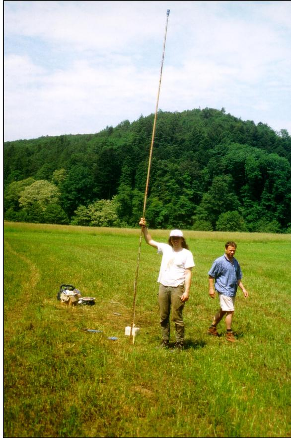
*Photo 5: Bohrstangen-Sondierung in der Aue des Tennenbächles (Mittlerer Talschwarzwald). Maximale Bohrtiefe 6 m, Durchmesser des Bohrkerns 2 cm (06.1999).*
