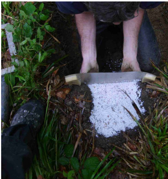
Foto 1: Volumenersatzprobe: Hohlraum der durch die Entnahme des Bodenmaterials entstanden ist wird mit Perlite wieder befüllt
