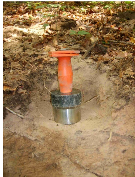
Foto 2: Stechzylinder zur Entnahme von 200 cm 3 Bodenmaterial in wenig steinigigen Bodenprofilen
