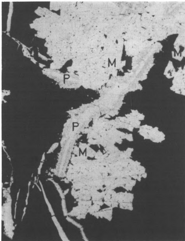
Abb. 2: Eisensulfid-Vorkommen im unteren Langenbach, Attental. Schnüre von Pyrit („P“, kubisches \text{FeS}_2 ) durchsetzen körnigen Markasit („M“, rhombisches \text{FeS}_2 ). Schwarz: Paragneis. Anschliff. Bildbreite 0,43 mm.
