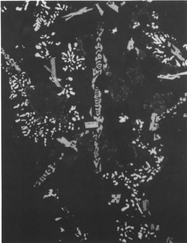
Abb. 8: Ausschnitt aus einem Gemenge von halbgeschmolzenem Erz und Tephrit, Stohren (Obermünstertal). Nadelige oder skelettförmige Magnetkies-Kristalle ( \text{FeS} , hell- grau), und runde Cuprit-Körnchen oder Cuprit-Skelette ( \text{Cu}_2\text{O} , weiß) in grauer wolkiger Glasmatrix. Anschliff. Bildbreite 0,48 mm.
