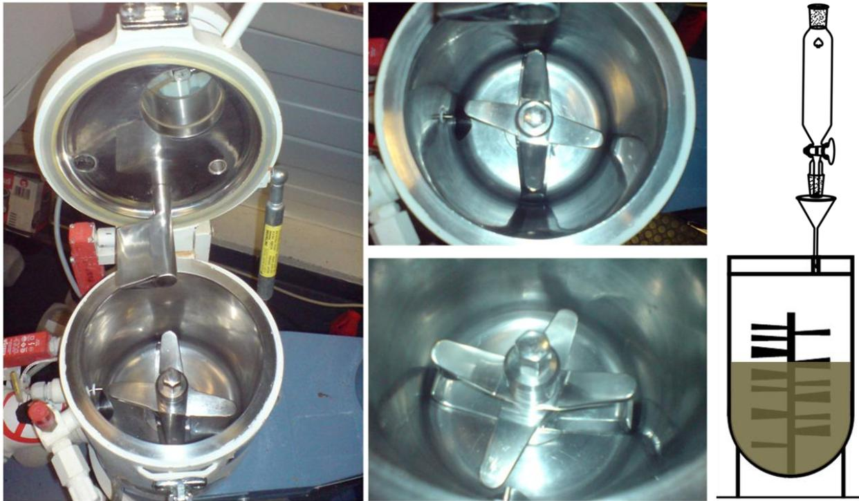
**Abbildung 3.1: Fluidmischer FM-4L (Thyssen-Henschel) (linkes Bild). Mitte: Mischkammer mit Mischflügel; Rechts: Schematischer Aufbau zur Bildung des oMMT-ESO-Dryblends.**
