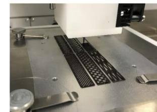
Abb.1: 3D-druckbares Polymer auf Holzbasis. Direktes Tintenschreiben mit lösungsmittelbasierter Bio-Tinte.
