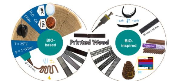
Abb2: Bi-O-AKTOR: Konzept eines vollständig bio-basierten und bio-inspirierten Material-integrierten Aktors auf Holzbasis.
