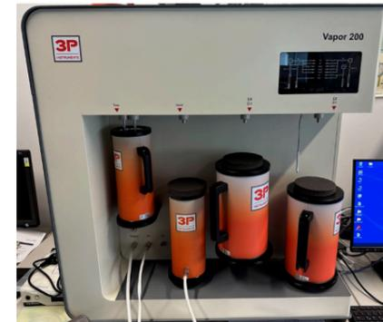
Fig.9: Sorptionsgeräte: 3 P Instruments Sync 200A und 3 P Instruments Vapor 200
