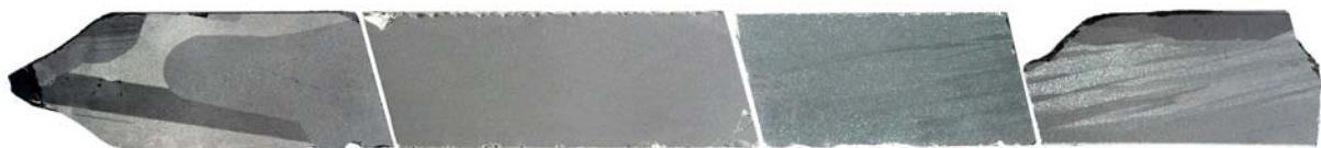
Abb. 6.13 Längsschnitt durch den Züchtungskörper WJ12 CdTe:V, gezüchtet in sandgestrahlter Ampulle.
