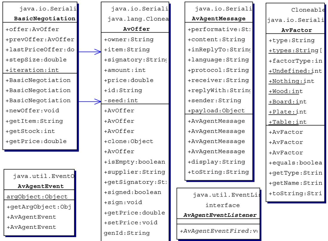
Abb. 53: UML-Klassendiagramm der Inter-Agenten-Kommunikation
