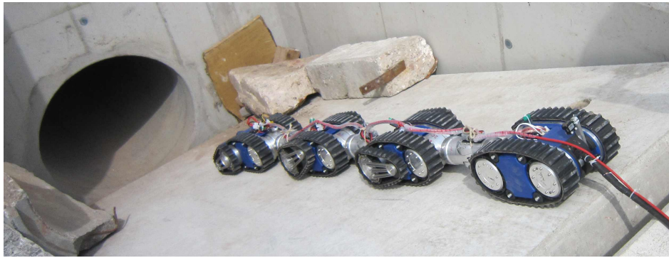
Abb. 5.15: Feldversuche mit dem Erkundungsroboter Moebhiu 2 s im Kanalsystem an der THW Bundesschule in Hoya, 2011.
